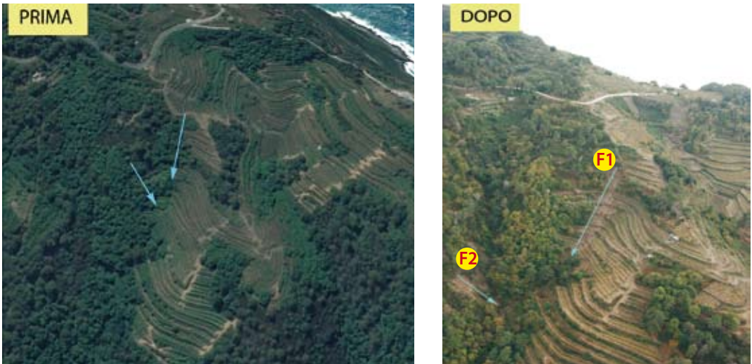
Fig. 6. (In alto a sinistra) La foto aerea del 2006; (a destra) la fotografia dello stesso luogo scattata il 2 novembre 2011. La frana è avvenuta su terrazzamenti coperti dal bosco. (Above, left) An aerial photograph of the year 2006; (right) the corresponding picture taken on 2 November 2011. The landslides occurred on abandoned terraces covered with woods-
