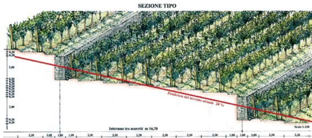
Fig. 8. Sezione tipo. Data l'abbondante presenza in loco di pietre, si è optato per la progettazione di terrazzamenti a scogliera, con un'altezza di 2,0 m, disposti lungo le curve di livello ad una distanza di circa 16,0 m l'uno dall'altro. Al fine di ottimizzare la meccanizzazione dei filari si è scelto di abbassare ulteriormente la pendenza della terrazza effettuando un gradino dopo il filare di circa 20 cm al fine di evitare una pendenza trasversale del 10%. Sample section. Given the abundance of rock on the site, we opted for 2 meter high a scogliera terraces arranged along contour lines about 16 m apart. To facilitate the mechanization of the vineyard, we decided to add a ca. 20 cm high step after each row to reduce the current 10% transversal acclivity of the terrace.
