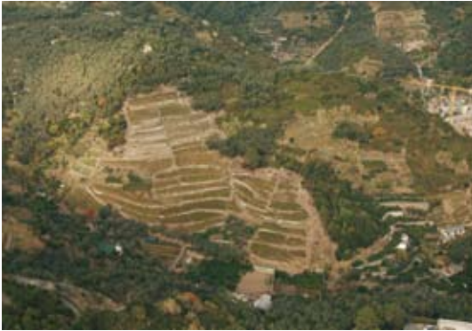
Fig. 8. (A sinistra) Evento franoso verificatosi a carico di un vigneto terrazzato adiacente ad un'area forestale. (Left) A landslide that impacted a terraced vineyard adjoining a wooded area.
